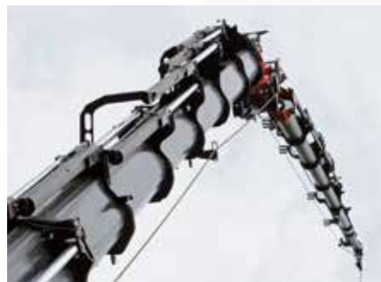
Uitschuifstelsel Optimale stabiliteit ook bij hoge reikwijdte
